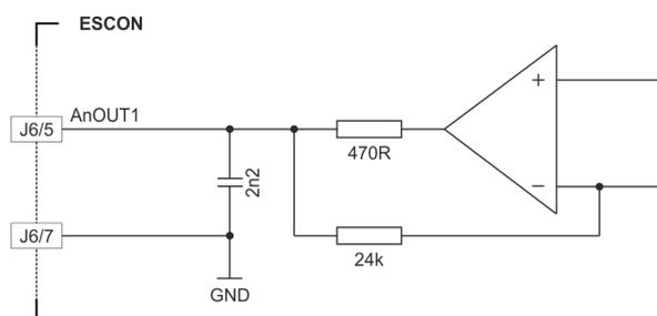
Figura 3-18 Circuito AnOUT1 (applicabile anche per AnOUT2)
