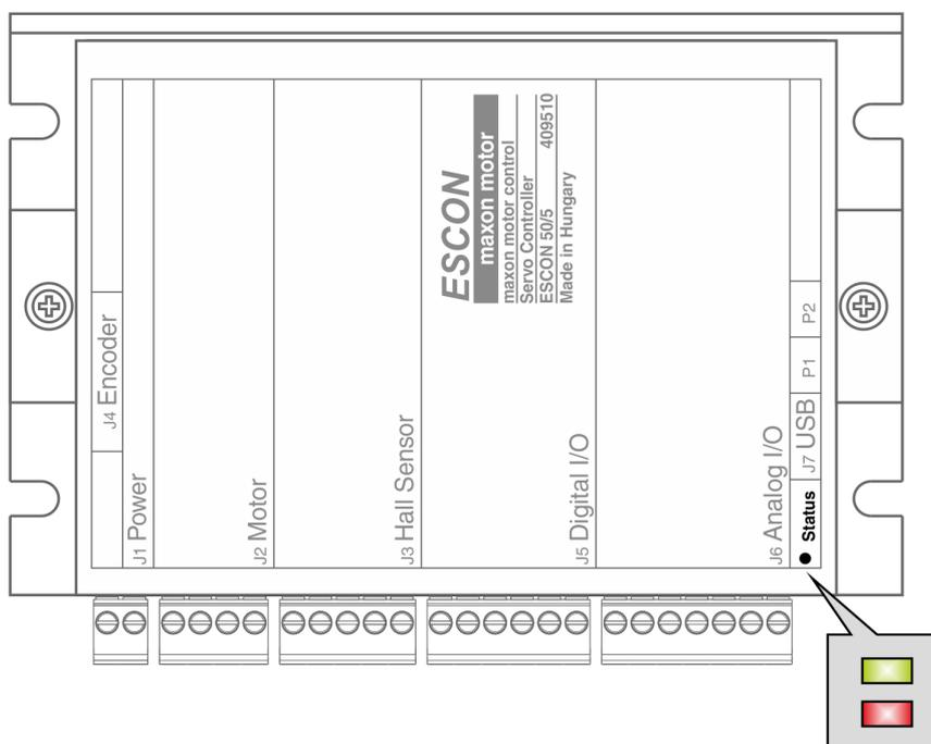
Figura 3-21 LED – Posizione di montaggio
