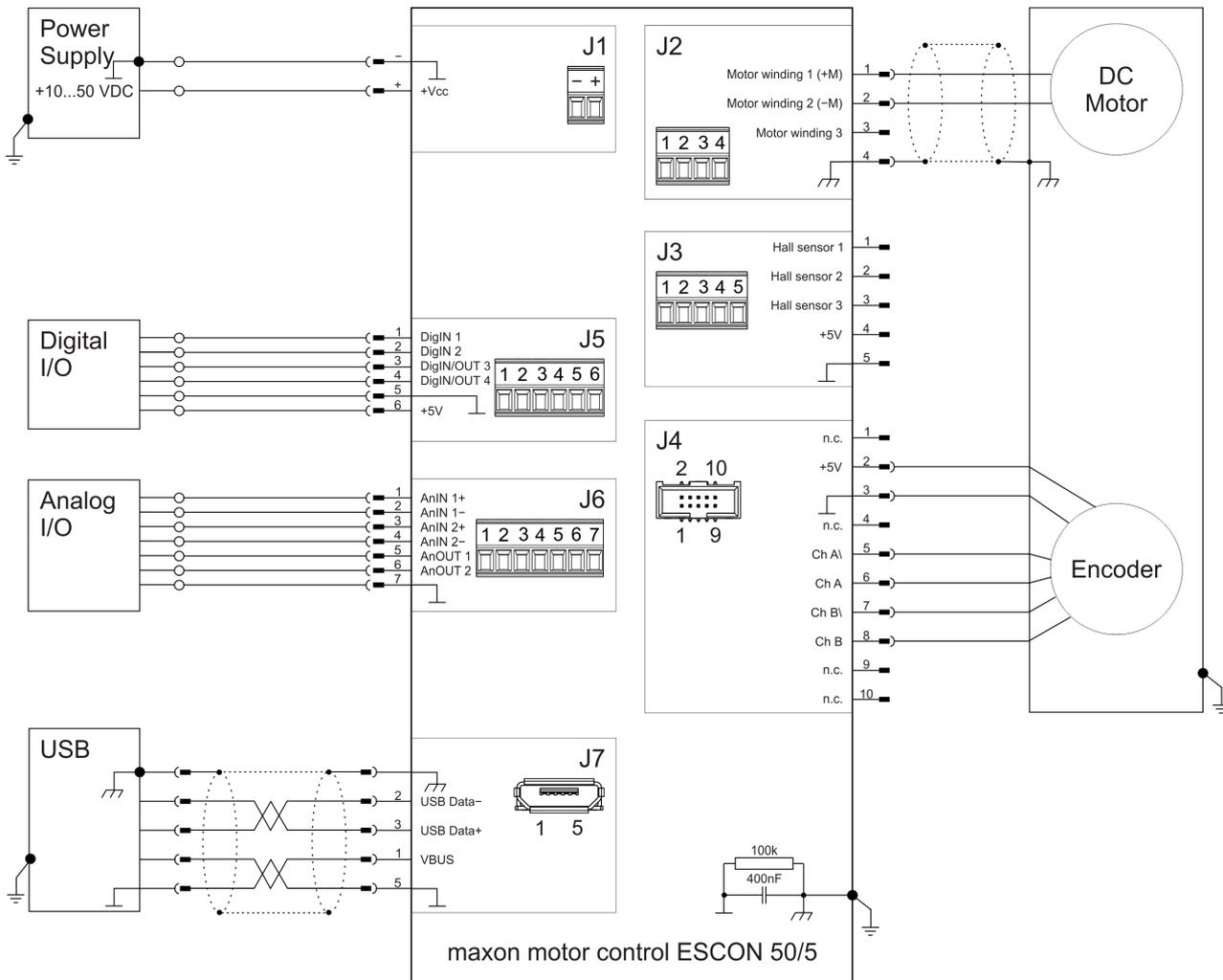
Figura 4-25 maxon DC motor con encoder (J2/J4)
