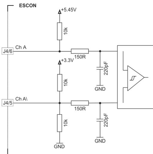
Figura 3-8 Circuito di ingresso encoder Ch A "differenziale" (applicabile anche per Ch B)
