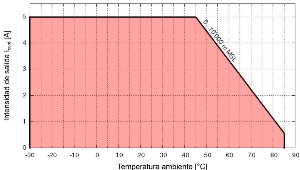
Figura 2-1 Derating de la intensidad de salida
