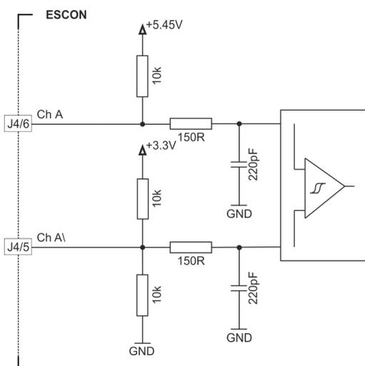
Figura 3-8 Encoder, circuito de entrada "diferencial" de Ch A (similar también para Ch B)
