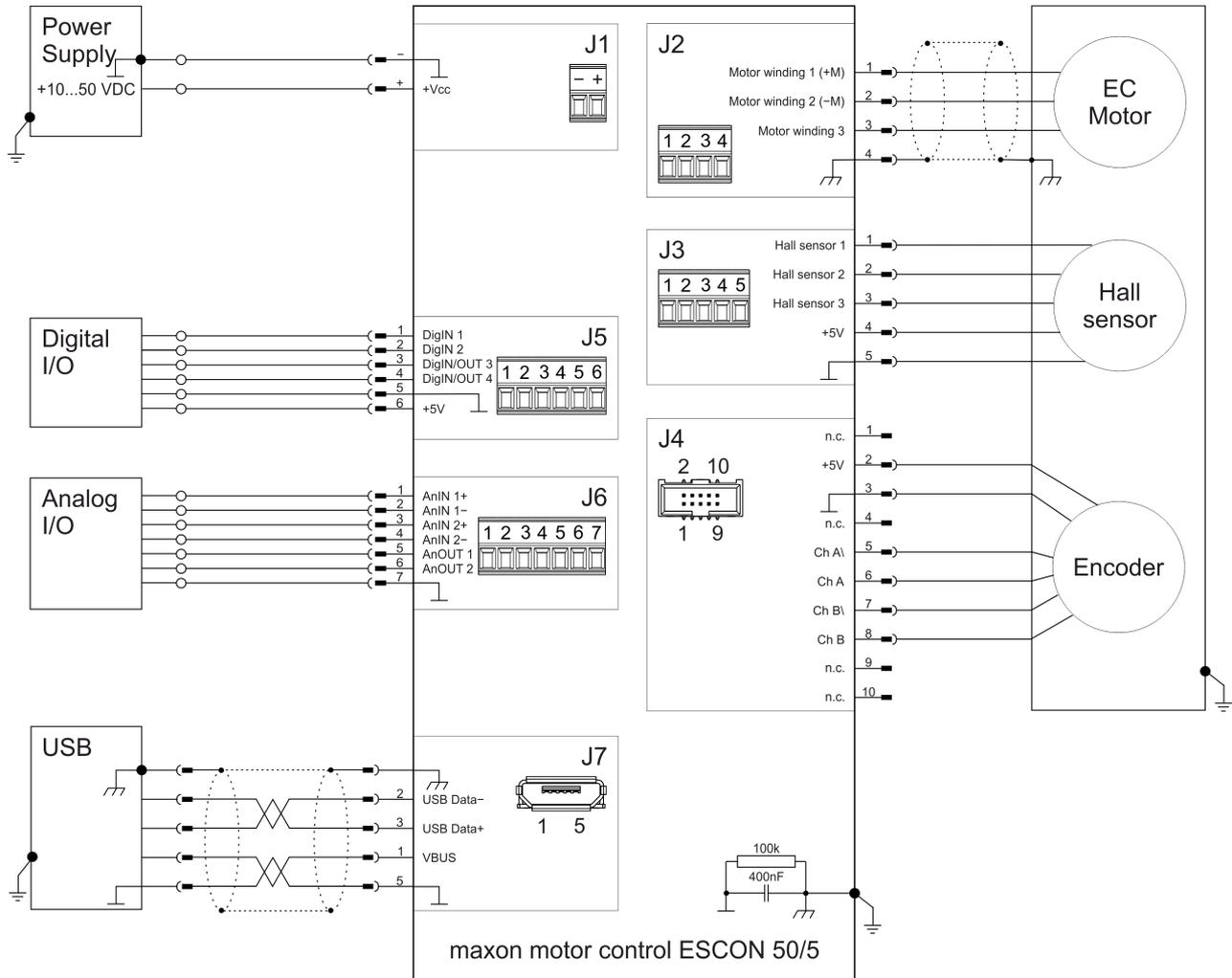
Figura 4-27 maxon EC motor con sensores Hall y encoder (J2 / J3 / J4)
