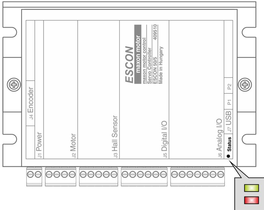
Figura 3-21 LEDs – Lugar de montaje
