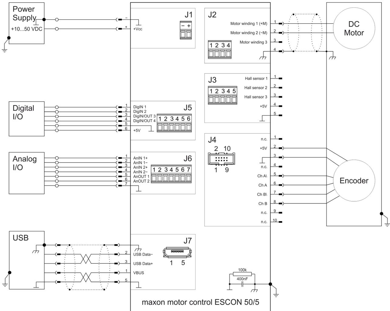
Figura 4-25 maxon DC motor con encoder (J2 / J4)
